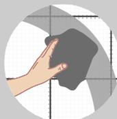
**ทำความสะอาดพื้นผิวหน้าโมเสก** หลังจากยาแนวแห้งหมด โดยใช้ฟองน้ำสะอาดชุบน้ำหมาดๆ เช็ดยาแนวส่วนเกินบนผิวหน้าโมเสกออกให้หมด ควรเปลี่ยนน้ำและล้างฟองน้ำบ่อยๆ จนผิวหน้าโมเสกใส
